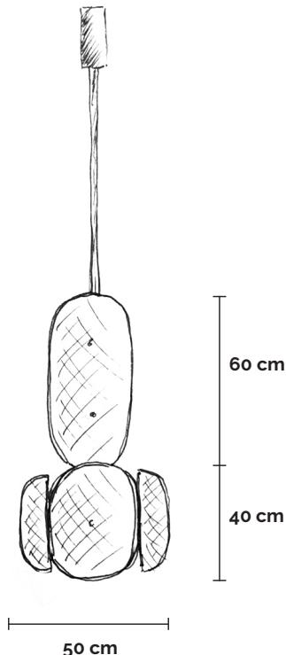
Fibre de verre avec un tressage carbone, travaillée au pinceau avec une résine époxy (traitée anti UV)
